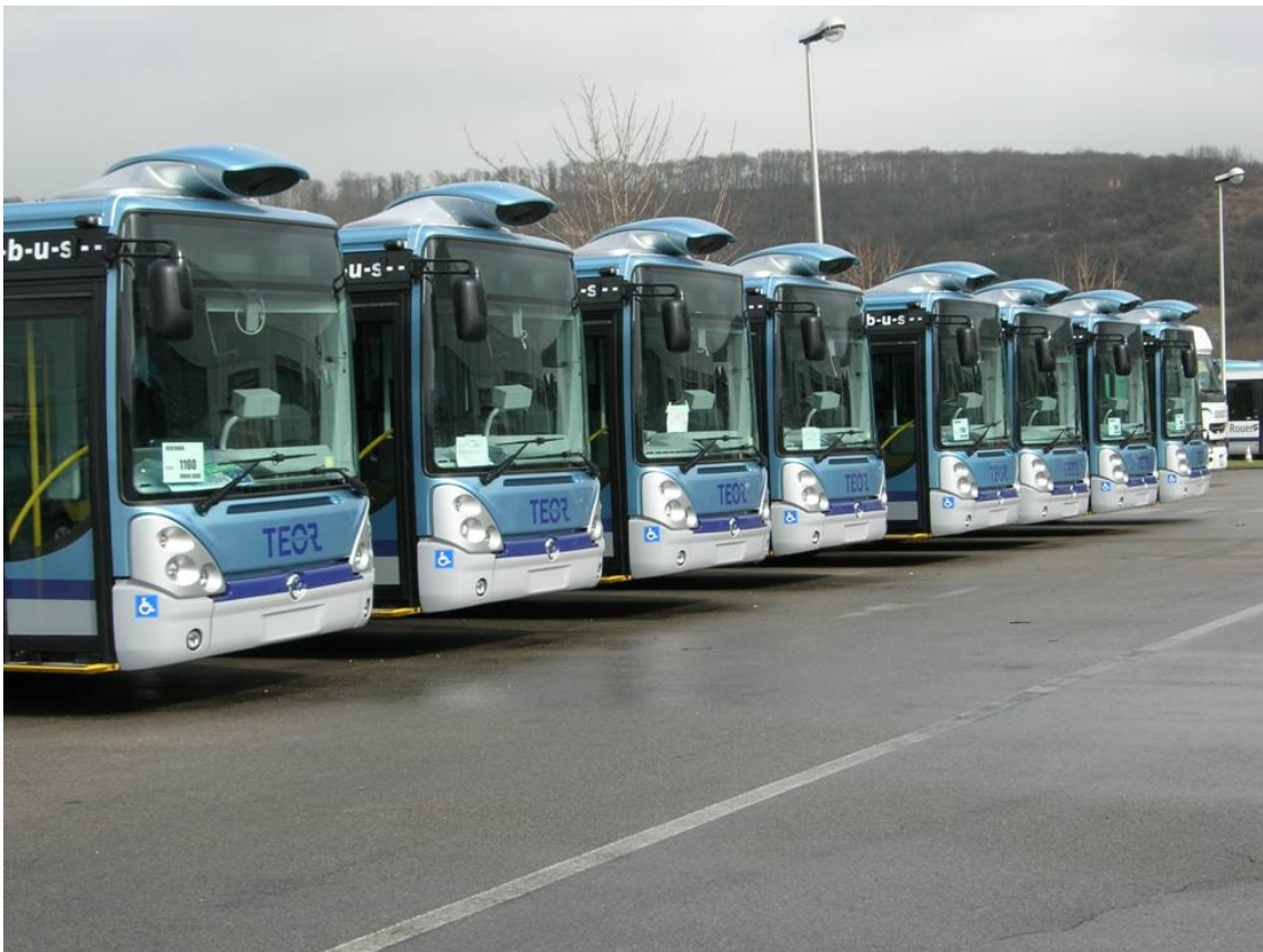
Arriba: buses guiados del sistema TEOR en Ruan, Francia. Las cámaras del sistema de guía óptico están ubicadas de manera característica sobre los techos, apuntando al centro de los carriles donde se localizan las demarcaciones. Foto: Communauté de l'Agglomération Rouen Elbeuf Austreberthe. Abajo: bus Phileas en Eindhoven, Holanda. Foto: S.P. Smiler.
